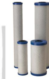
Los Cartuchos de Bloque de Carbón Serie EP Pentair Pentek® se fabrican mediante un proceso de clasificación de filtración nominal de 5 micrones y gran capacidad de reserva de suciedad. El diseño de alta porosidad ayuda a evitar que el cartucho se conecte antes de que se agote su capacidad de adsorción, al maximizar la utilización del carbón mientras mantiene la caída de presión baja.
